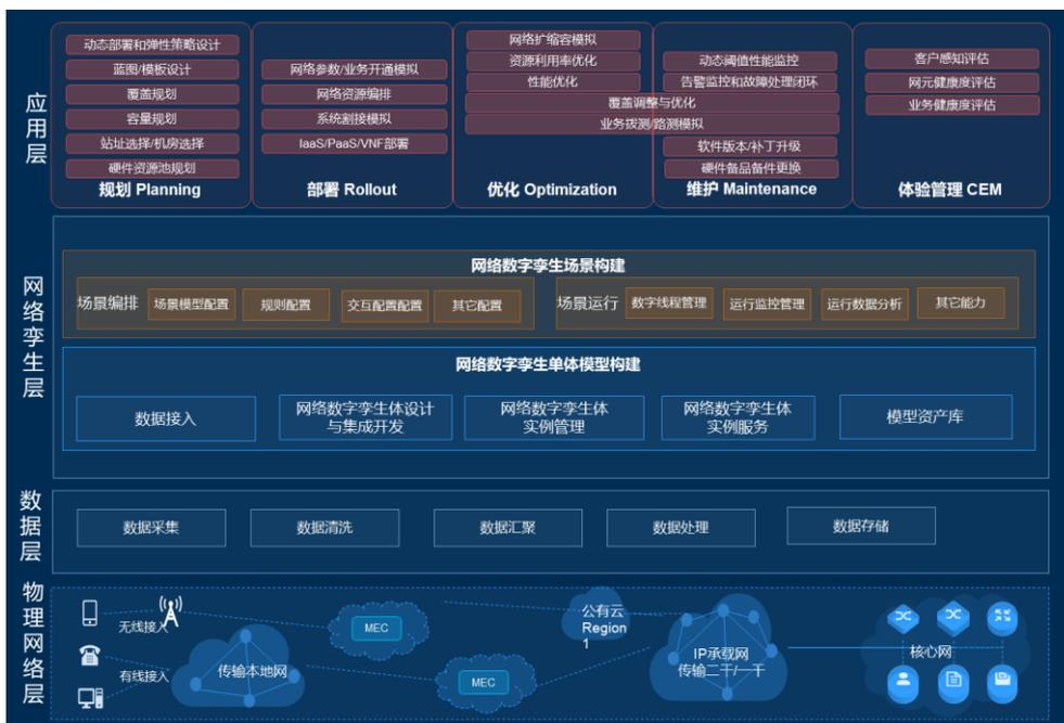
图 5-1 数字孪生网络整体架构
