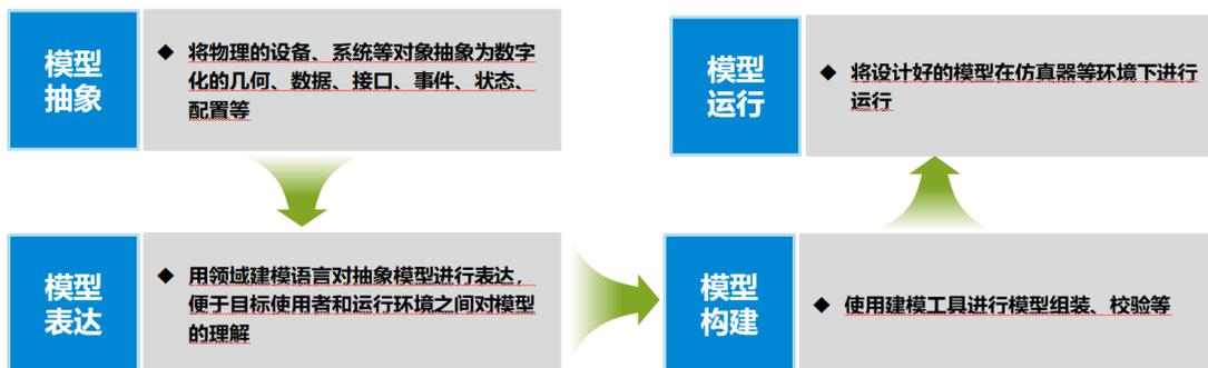
图 2-4 数字孪生模型构建流程
